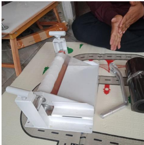
Gambar 1. Alat bantu pencetak opak ketan hasil rancang tim pelaksana
