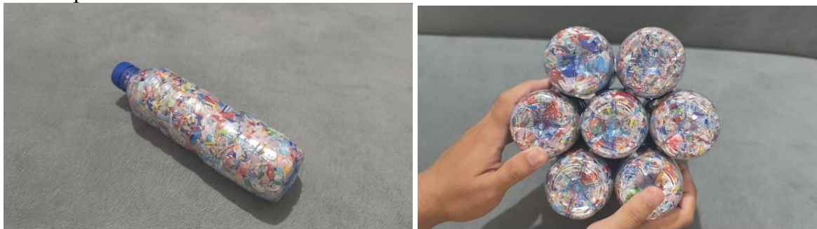
Gambar 2. Hasil Ecobrick dan Module Ecobrick
